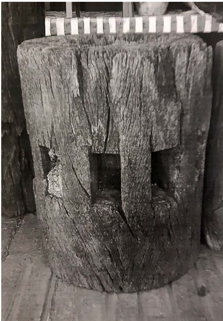
Masa de una rueda con las caladuras para los rayos
